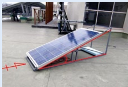
太陽光発電パネルの発熱量の推定実験 (傾斜角30°は日本国内における一般的な角度)
